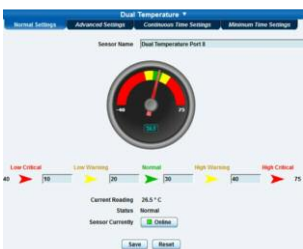
Abb.: Die Anzeige der aktuellen Messwerte kann im Webinterface der securityProbe Alarmserver individualisiert werden.
